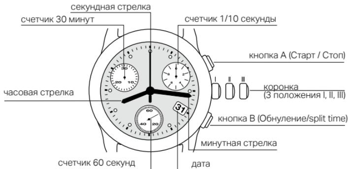
Перед каждым хронометражем стрелки хронографа должны стоять в исходном положении (см. порядок обнуления счетчиков).
