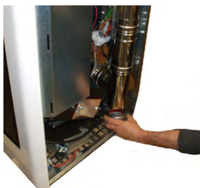
Fig. 82 - Reinigung des Rauchgaskanals
