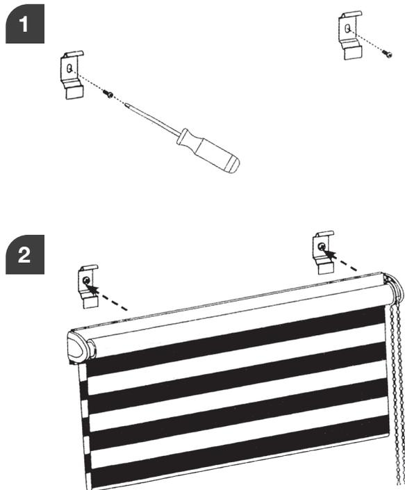
Bei Montage an die Decke muss das Getriebe aus der Endkappe genommen, Kette nach unten gedreht und danach wieder in die Endkappe eingeklickt werden.
