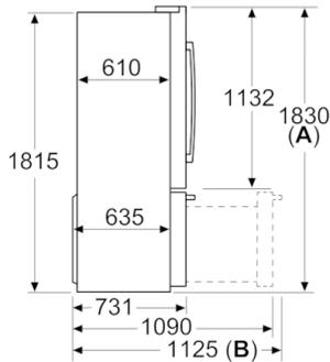
**A:** Front ist von 1830 bis 1847 (bei voll ausgezogenen vorderen Nivellierfüßen) verstellbar
