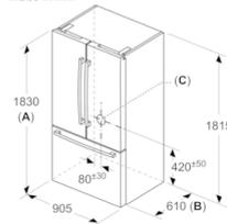
**A:** Front ist von 1830 bis 1847 (bei voll ausgezogenen vorderen Nivellierfüßen) verstellbar
