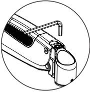
**HINWEIS:** Bei leichteren Monitoren im Uhrzeigersinn drehen, um die Spannung zu verringern; bei schwereren Monitoren gegen den Uhrzeigersinn drehen, um die Spannung zu erhöhen. Fahren Sie mit der Einstellung fort, bis der Monitor in jeder Position stillhält.
