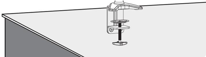
**Ziehen Sie das Klemmstück mit der Klemmschraube fest, sodass die Halterung sicher am Schreibtisch befestigt ist.**
