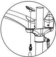
**Führen Sie die Schraube durch die Bohrung vom Trägerteil zur Zierkappe.**
