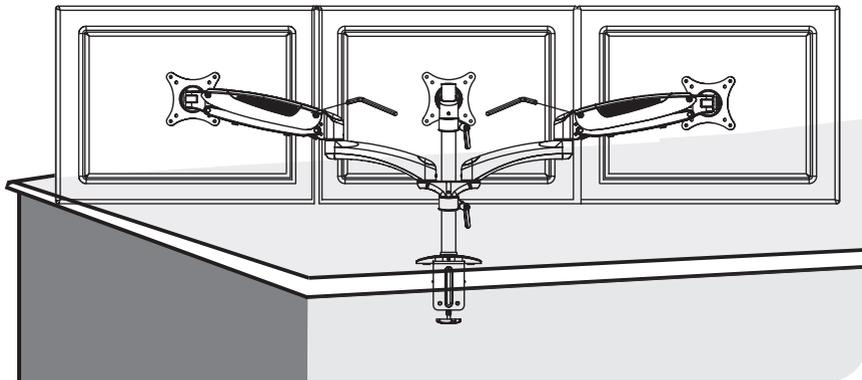
**Stellen Sie die Höhenspannung des Gasfederarms mit einem Innensechskantschlüssel ein, damit Monitore mit unterschiedlichem Gewicht in jeder Position stillhalten.**
