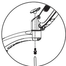
**Führen Sie die Schraube durch die Bohrung vom Auslegerarm zur Zierkappe.**
