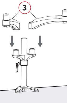
**Setzen Sie das Befestigungselement aus Stahl in das Stahlrohr ein.**
