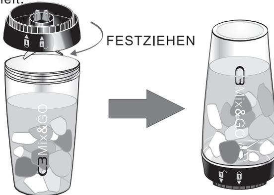
5. Stellen Sie sicher, dass der Pfeil auf der Motoreinheit auf UNLOCK (ENTRIEGELT) steht und drehen Sie die Flaschenbaugruppe im Uhrzeigersinn auf LOCK (VERRIEGELT), bis es klickt.
