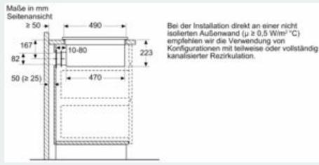
Bei der Installation direkt an einer nicht isolierten Außenwand ( $\mu \geq 0,5 \text{ W/m}^2 \cdot \text{K}$ ) empfehlen wir die Verwendung von Konfigurationen mit teilweise oder vollständig kanalisierter Rezirkulation.
