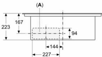
A: Direkt an der Rückseite angeschlossen
