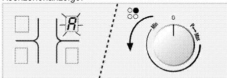
2. Drehen Sie den Kochzonenknopf zum Einstellen der Temperaturstufe im Uhrzeigersinn (im Beispiel wird die Stufe 7 ausgewählt).
