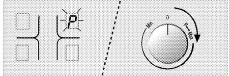
2. Drehen Sie den Kochzonenknopf zur Aktivierung der Hochleistung-Funktion (Turbo, „P“) in die rechte Überdrehposition. „P“ erscheint in der entsprechenden Kochzonenanzeige.
