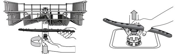
Zur Abnahme des oberen Sprüharms drehen Sie den Kunststoffring im Uhrzeigersinn ab.
