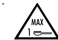
Niemals mehr als 1 gestrichenen Messlöffel einfüllen, da das Maschineninnere sonst verschmutzen oder der Einfüllschacht verstopfen könnte.
