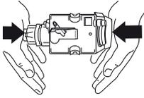
Wenn die Brüheinheit sich nur schwer einsetzen lässt, muss diese (vor dem Einsetzen) auf die richtige Größe gebracht werden, und zwar indem sie gleichzeitig
