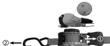
Bild 2: Ausrollen des Spanngurtes
