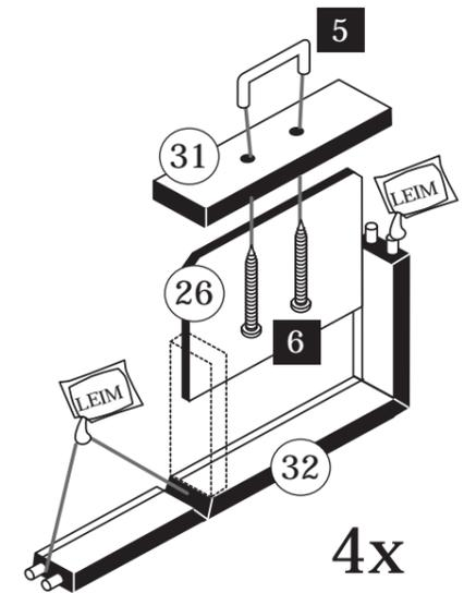
Bitte die Griff-schraubenlöcher mit einem Holzbohrer durchbohren. Halten Sie dabei einen Brett von der anderen Seite gegen die Fläche, um eine sauberen Durchgangsbohrung zu bekommen!
