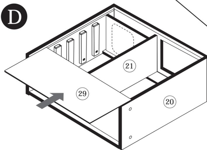
Bitte die Position des Bodens und der Mittelwand genau auf der Rückwand anzeichnen.
