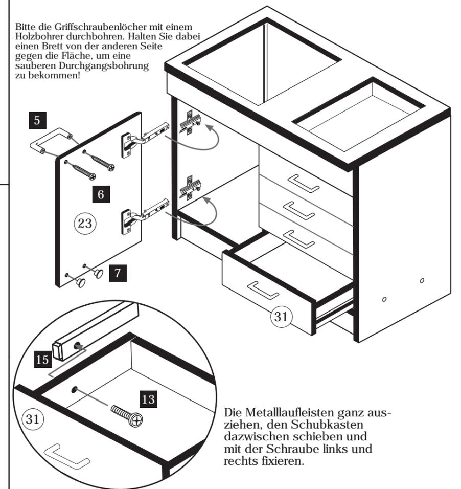
Die Metalllaufleisten ganz ausziehen, den Schubkasten dazwischen schieben und mit der Schraube links und rechts fixieren.
