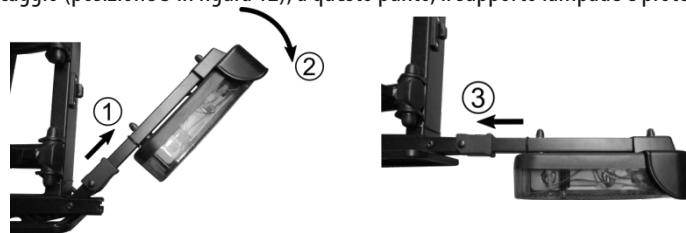
Figura 12: Bloccaggio supporto lampade
