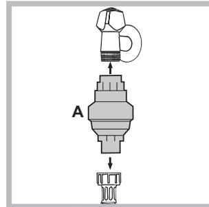
1. Schrauben Sie die Vorrichtung „Water Block“ (A) an einen Kaltwasserhahn mit 3/4-GAS-Gewindeanschluss an und schrauben Sie dann den Wasserschlauch an die Vorrichtung. Lassen Sie das Wasser vor dem Anschluss so
