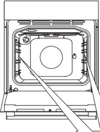
Entfernen Sie die Draht- bzw. Ausziehführungen.
