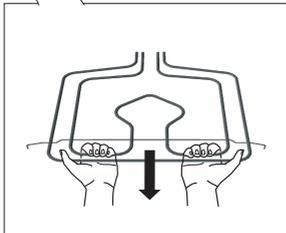
Ziehen Sie das Heizelement so lange, bis sich die Querstange entriegelt und aus den Halterungen auf der linken und rechten Seite des Garraums herauspringt.
