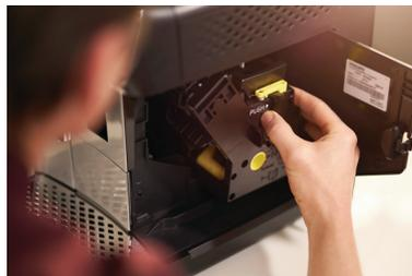
Die Brühgruppe ist das Herz jedes Kaffeevollautomaten und sollte regelmäßig gereinigt werden. Die herausnehmbare Brühgruppe ermöglicht Ihnen eine gründliche Reinigung, indem Sie sie einfach unter fließendem Wasser abspülen können.
