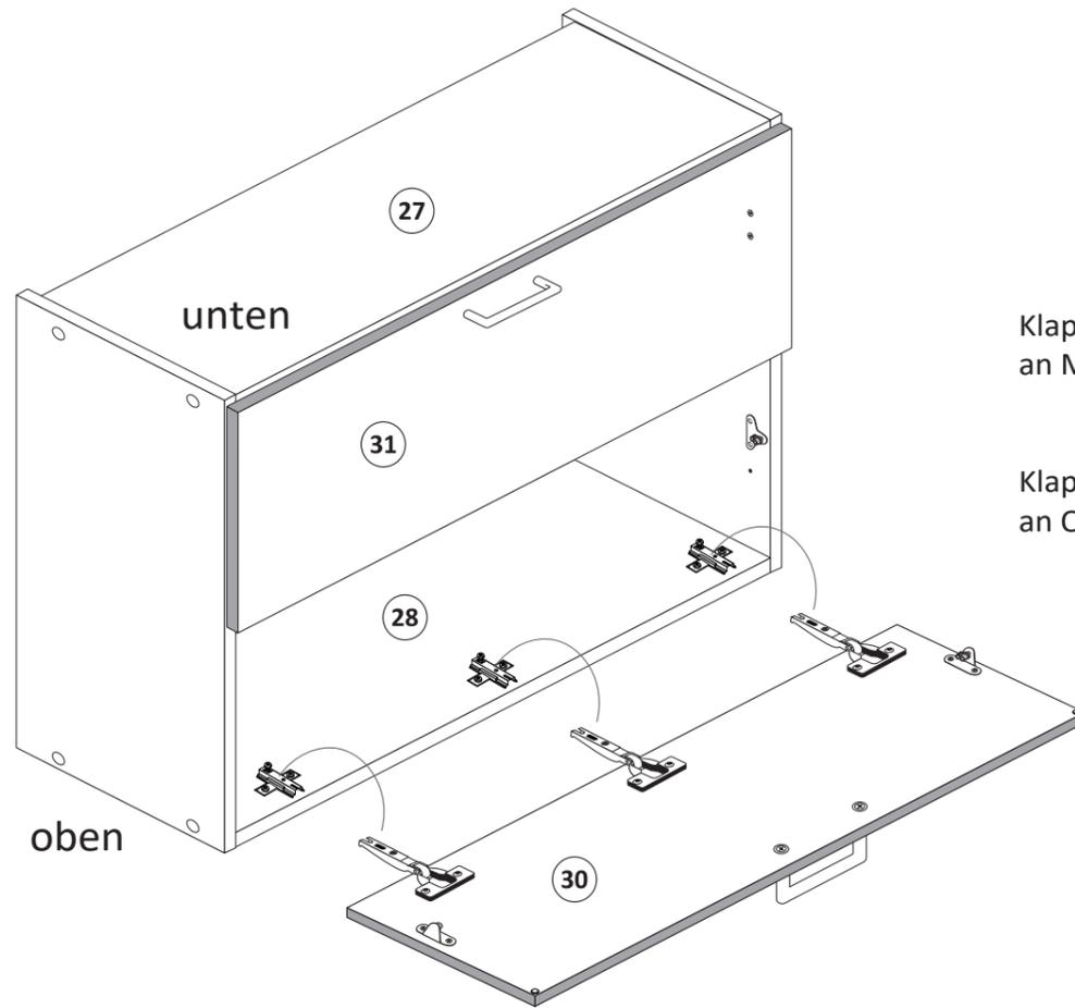
Klappe **31** mit Scharnieren **6** an Mittelboden **29** montieren !
