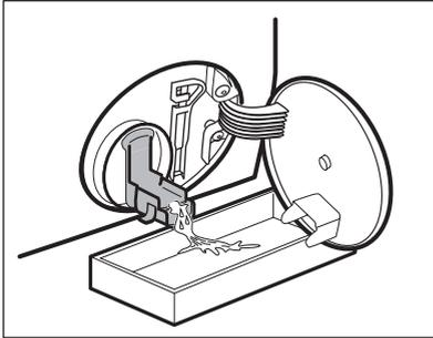
5. Wenn der Behälter voll ist, schließen Sie den Ablaufkanal und leeren Sie den Behälter.
