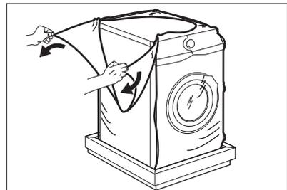
3. Entfernen Sie die Karton-Abdeckung und Styroporverpackungsteile.
