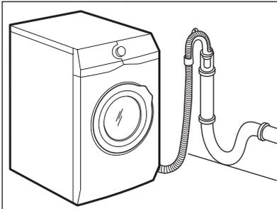
**i** Das Ende des Ablaufschlauchs muss stets belüftet sein, d. h. der Innendurchmesser des Ablaufrohrs (min. 38 mm - min. 1,5") muss größer sein als der Außendurchmesser des Ablaufschlauchs.
