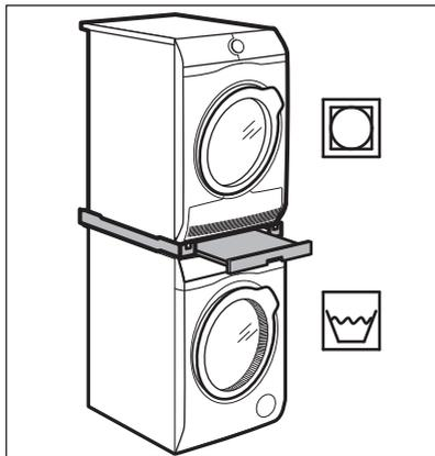
Der Wäschetrockner kann **nur mit dem von AEG hergestellten und genehmigten Bausatz Wasch-Trocken-Säule auf der Waschmaschine montiert werden.**
