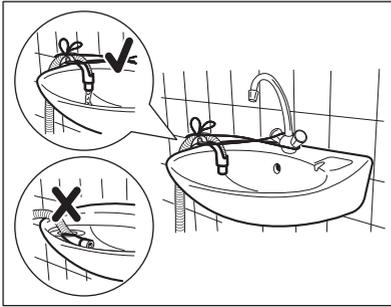
**i** Achten Sie darauf, dass sich das Ende des Ablaufschlauchs nicht im Wasser befindet. Anderenfalls könnte Schmutzwasser in das Gerät zurückfließen.
