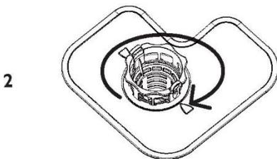
Setzen Sie den Ablauffilter wieder in den Geschirrspülerboden ein. Drehen Sie ihn 2 Mal im Uhrzeigersinn, bis er einrastet.
