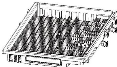
Verwenden Sie den Korb, um Besteck und Utensilien zu sichern. Legen Sie das Besteck in die Aussparungen, um es zu sichern. Legen Sie größere Utensilien in die Mitte des Korbs. Schieben Sie die Seitenteile in die Mitte, um mehr Platz für die Gegenstände darunter zu schaffen.
