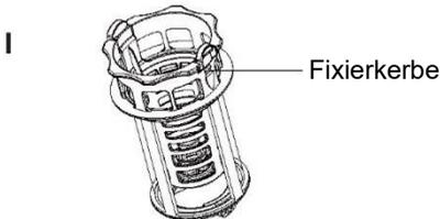
Richten Sie die Filterkappe mit der Kerbe am Filtersockel aus. Vergewissern Sie sich, dass die Verschlussstruktur vorhanden ist.
