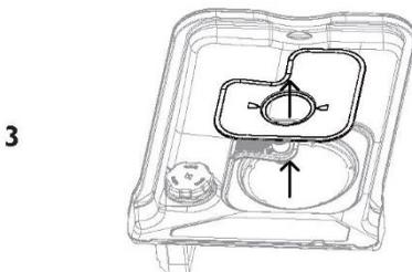
Entfernen Sie den Ablauffilter und die Filterplatte. Benutzen Sie einen Schwamm, um das restliche Wasser von der Unterseite zu entfernen, bevor Sie sie wieder einsetzen.
