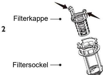
Trennen Sie die Filterkappe vom Sockel, indem Sie die Entriegelungsknöpfe drücken und die Kappe anheben.
