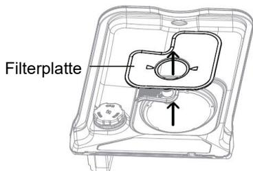
Heben Sie bei abgenommenem Filter die Filterplatte vorsichtig nach oben und heraus. Reinigen Sie ihn unter heißem Wasser und spülen Sie ihn gründlich aus.
