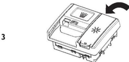
Schließen Sie den Deckel und achten Sie darauf, dass er mit einem Klick einrastet.
