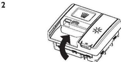
Entfernen Sie überschüssiges Spülmittel und schieben Sie den Deckel zu. Er rastet ein. Füllen Sie bei Bedarf zusätzliches Spülmittel in das Vorspülmittelfach an der Oberseite des Faches.
