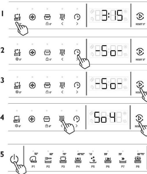
Stellen Sie sicher, dass kein Spülvorgang läuft. Halten Sie die Taste **RESET** 5 Sekunden lang gedrückt, um das Menü aufzurufen.
