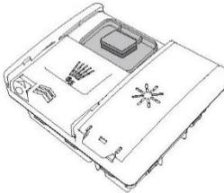
Füllen Sie Spülmittel in das Fach und schließen Sie den Deckel.
