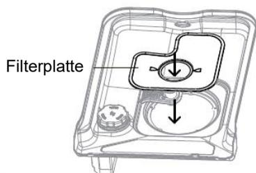
Schieben Sie die Filterplatte unter die Halteklammern an der Rückseite des Abflusses und drücken Sie sie fest in ihre Position. Vergewissern Sie sich, dass die Filterplatte bündig mit dem Boden des Geschirrspülers ist.
