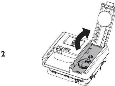
Heben Sie den Deckel an und füllen Sie den Klarspüler in die Öffnung. Füllen Sie nicht über die MAX-Linie hinaus. Achten Sie darauf, dass Sie nichts auf die Tür oder den Spülmittelbehälter verschütten.
