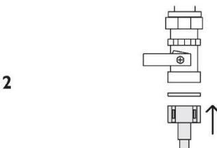
Lassen Sie das Wasser aus den Schläuchen, dem Zulaufrohr und dem Wasserventil ab und fangen Sie das Wasser in einem Eimer oder einer Wanne auf.
