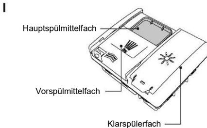
Prüfen Sie, ob das Fach leer und trocken ist. Füllen Sie Spülmittel in Pulverform oder Tabs in das Spülmittelfach.
