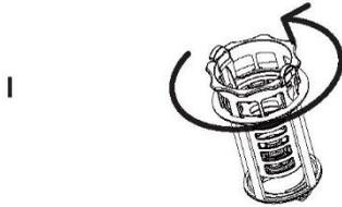
Drehen Sie den Filter gegen den Uhrzeigersinn, um ihn zu lösen. Heben Sie ihn an, um ihn zu entfernen.
