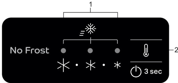
1. Anzeige-LEDs (zur Anzeige der aktuellen Temperatureinstellung oder der Extra Einfrieren-Funktion)
