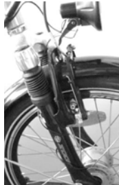
Federgabel mit Elastomer/ Federdämpfung
