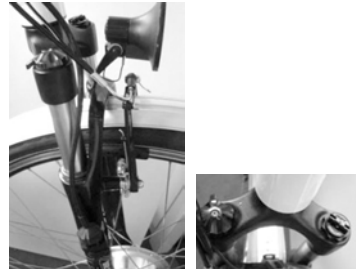
Einstellbare Federgabel mit Lock-Out (Sperrung) und Justiermöglichkeit
