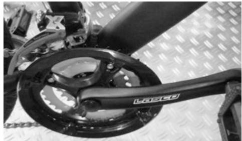
Front chain ring with derailleur
