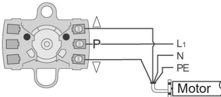
**ANSCHLUSS AN EINEN TORANTRIEB (Tastbetrieb)**
