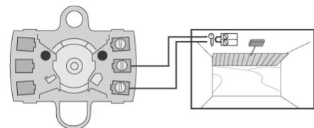
**ANSCHLUSS AN ZWEI TORANTRIEBE (Tastbetrieb)**
