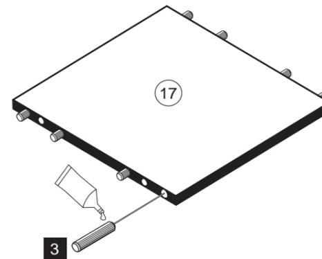
Bitte die Griff-schraubenlöcher durchbohren und die Griffschrauben vorsichtig mit dem Handschraubendreher durchschrauben, nicht durchschlagen!
