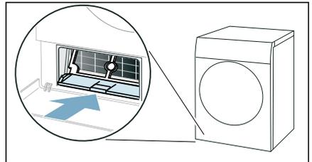
10. Wärmetauscher-Abdeckung am Griff einschieben.
