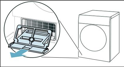
c) Einsatz unter fließendem Wasser abspülen und abtrocknen.
