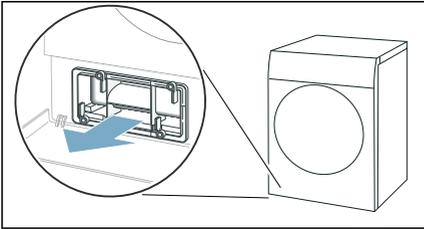
5. Filtermatte vorsichtig von der Wärmetauscher-Abdeckung ziehen.
