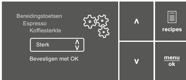
Afb. 6: Display (voorbeeld) en bedieningstoetsen om te navigeren
