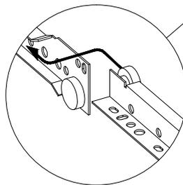
"Die Schubkastenschiene kann bei Bedarf durch Lösen und Fixieren der Schraube am Langloch eingestellt und nachjustiert werden"
