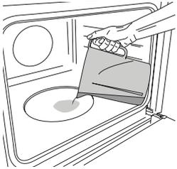
Nur wenn der Ofen kalt ist, die Aussparung des Garraums mit der in der entsprechenden Gartabelle empfohlenen Menge an Trinkwasser füllen. Stellen Sie die Speisen in den Ofen.
