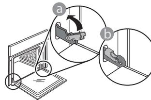
4. Die Tür senken und anschließend vollständig öffnen. Die Haken in ihre Ausgangsposition senken: Sicherstellen, dass die Haken vollständig gesenkt werden.
