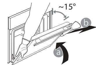
2. Die Tür so weit wie möglich schließen. Die Tür mit beiden Händen festhalten – diese nicht am Griff festhalten. Die Tür einfach entfernen, indem sie weiter geschlossen und gleichzeitig nach oben gezogen wird, bis sie sich aus
