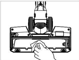
Reinigen Sie die Elektrobürste nur mit einem leicht feuchten Tuch oder einer weichen Bürste.
