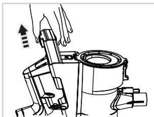
Der Akku kann außerdem in der separaten Aufbewahrungsstation aufgeladen werden. Entnehmen Sie dazu den Akku aus dem Handgerät, in dem Sie den Entriegelungsknopf am Ende des Akkus drücken und ihn herausziehen.
