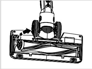
Lösen Sie die Verschraubung und entfernen Sie die Abdeckung an der Seite.
