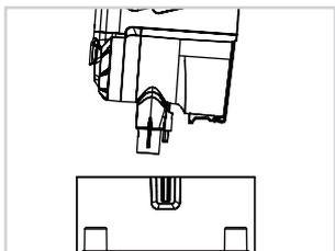
Speziell konstruiert zur platzsparenden und sicheren Aufbewahrung des Gerätes. Trennen Sie das Saugrohr vom Handgerät und setzen Sie das Handgerät wie abgebildet auf die Aufbewehrungsstation. An der Vorderseite befinden sich eine Aussparung zur Aufnahme der Elektrobürste (mit oder ohne Saugrohr) sowie 2 Aufnahmen für Zubehörteile. Zusätzlich kann die Aufbewehrungsstation als Ladestation genutzt werden (siehe: „Akku laden“).
