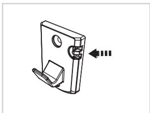
Befestigen Sie die Wandhalterung mit den beigefügten Schrauben an der gewünschten Stelle. Vergewissern Sie sich, dass hinter der Montagefläche keine Rohre oder elektrischen Kabel liegen. Die Aussparung in der Halterung kann als Kabelhalterung benutzt werden, damit das Ladegerät nicht auf den Boden hängt, wenn es nicht benutzt wird.
