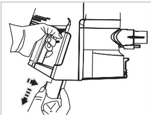
Schalten Sie das Gerät aus. Drücken und halten Sie den Entriegelungsknopf am Akku. Entnehmen Sie den Akku.
