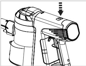
Durch Drücken des Boost-Knopfes maximieren Sie die Saugleistung. Beim Ausschalten des Gerätes wird der Boost-Modus automatisch deaktiviert. Sie können den Boost-Modus auch durch erneutes Drücken des Boost-Knopfes abschalten.
