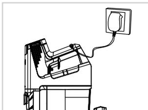
Während der Nutzung des Staubsaugers leuchtet die Ladekontrollleuchte blau. Bei niedrigem Akku-Stand wechselt die Farbe zu rot. Zum Aufladen des Akkus verbinden Sie die Ladebuchse mit Hilfe des Ladegeräts mit einer geeigneten Steckdose. Während des Ladevorgangs blinkt die Ladekontrollleuchte blau. Wenn sie erlischt, ist der Akku vollständig aufgeladen.
