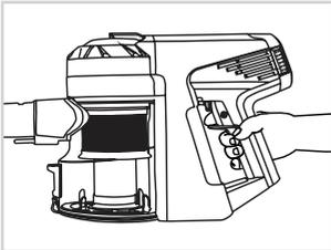
Um den Staubsauger einzuschalten, drücken Sie den An-/Ausrichter. Der Staubsauger läuft, so lange Sie den Schalter gedrückt halten. Sie können auch den Feststellhebel nutzen, um das Gerät auf Dauerbetrieb zu schalten.
