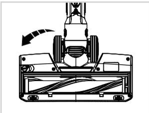
Achten Sie beim Einsetzen der Rolle in die Elektrobürste auf die korrekte Positionierung. Achten Sie dazu auf die entsprechenden Aussparungen. Setzen Sie die Abdeckung wieder ein und schließen Sie die Verschraubung.
