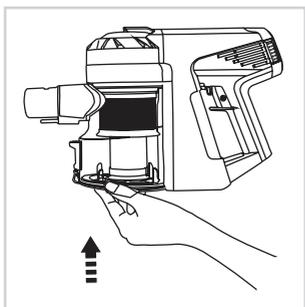
Verschließen Sie die Klappe des Staub-Behälters nach dem Entleeren wieder ordnungsgemäß.
