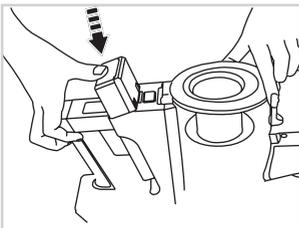
Neuen Akku einsetzen und darauf achten, dass der Akku hörbar einrastet. Sollte sich der Akku nicht vollständig ins Handgerät einschieben lassen, prüfen Sie die korrekte Positionierung.
