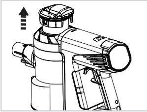
Ziehen Sie den Vormotorfilter einfach nach oben aus dem Handgerät heraus. Beide Bestandteile (der äußere Stoffring und der innere Schaumstoffring) können ausgeklopft oder bei Bedarf unter fließendem Wasser gereinigt werden.
