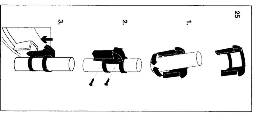
Montageabbildungen · Assembling the Appliance · Illustrations pour le montage ·
