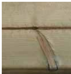
Nerves and long knots Nervios y nudos alargados Nervures et noeuds longs Geäder und lange knoten Nervature e nodi ingranditi Houtnerf en verlengde kwasten Nervuras e nós alargados
