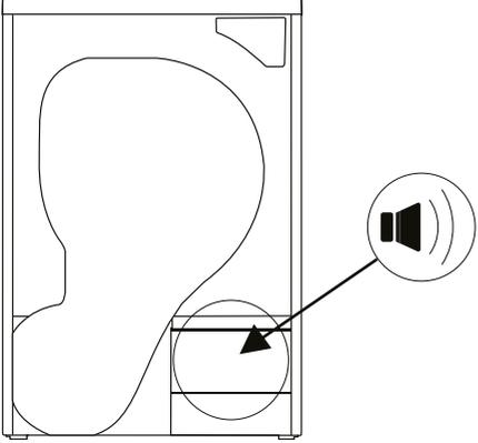
A line drawing of a washing machine drum. An arrow points from a circular speaker icon to a small circular area at the bottom of the drum, representing the pump. The speaker icon has three curved lines indicating sound waves.                                 | <p><b>Pumpgeräusche</b></p> <p>Die Pumpe wird beim Einschalten der Maschine und zu bestimmten Zeiten während des Betriebs aktiviert. Während dieser Vorgänge ist es normal, Pumpen- und Wassergeräusche zu hören.</p> |
