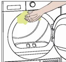
Öffnen Sie die Trocknertür und reinigen Sie alle Innenflächen sowie die Dichtung mit einem weichen, angefeuchteten Tuch.
