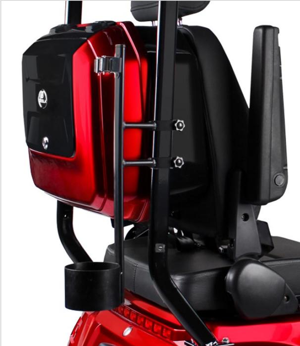
Das Elektromobil ist mit einer praktischen, bereits montierten Stockhalterung ausgestattet. Die Halterung befindet sich auf der rechten Seite (in Fahrtrichtung) hinter dem Sitz, seitlich neben dem Heckkoffer. Diese Position ermöglicht einen bequemen und schnellen Zugriff auf Ihre Gehhilfe.
