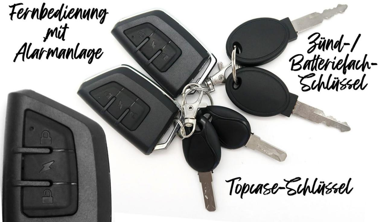
Mit der oberen Taste
