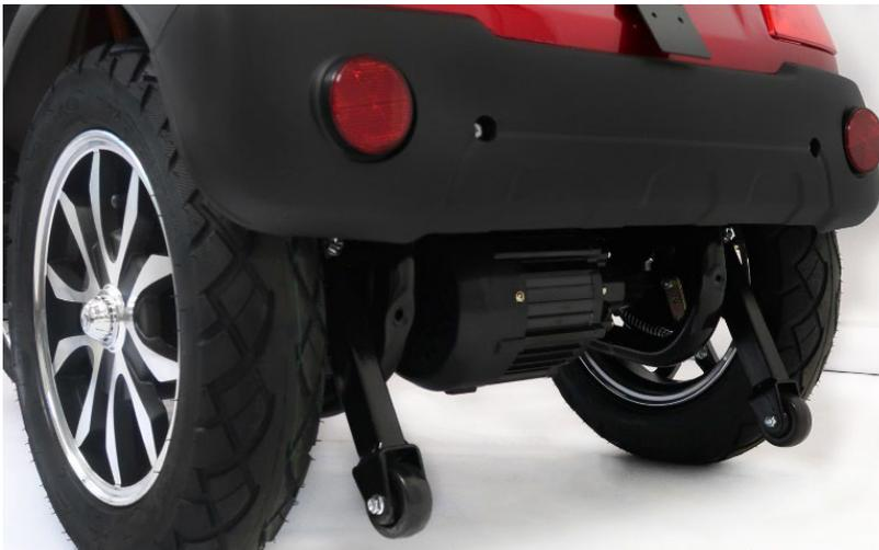
Die Kippsicherheit des E-Mobils wird durch speziell konzipierte Anti-Tipp-Räder gewährleistet. Diese Räder sind fest am Fahrzeug montiert und dienen dazu, ein Kippen nach hinten zu vermeiden – insbesondere bei Fahrten über Steigungen, Gefälle oder unebenes Gelände.
