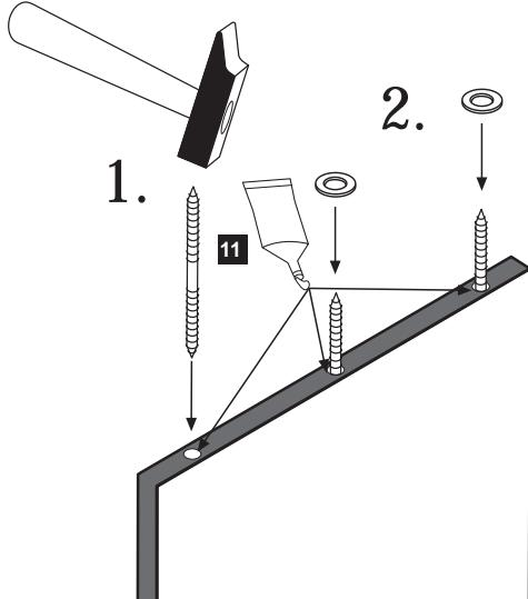
Bitte verwenden Sie beim Einschlagen eine Zulage zum Schutz der Stirnkante!
