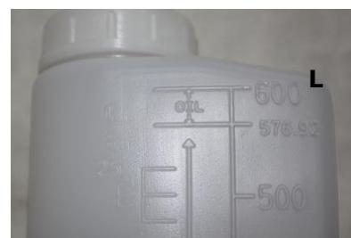
Möchten Sie ihr Benzin-Öl-Gemisch selbst erstellen, so tun Sie das mit dem Mischbehälter L, mit dem Mischverhältnis 40:1 (Markierungen auf dem Mischbehälter -> 40 Teile Benzin, 1 Teil Öl). Füllen Sie dieses Gemisch in den Tank M ein. Vor Jeder Inbetriebnahme Tank gut schütteln!
