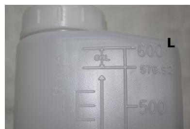
Si quiere preparar su propia mezcla de gasolina-aceite, use el recipiente de mezcla **L**, con la relación de mezcla de 40:1 (marcas en el recipiente de mezcla - gasolina > 40 partes, 1 parte de aceite). Llene esta mezcla en el tanque **M**. **iAntes de cada puesta en marcha, agitar bien el depósito!**
