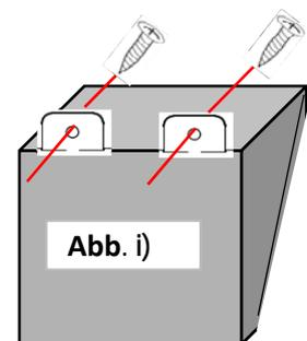
25. Montieren Sie die Kohlefilter seitlich am Motor. (Siehe Bedienungsanleitungs-Kapitel "Einsatz der Kohlefilter")
