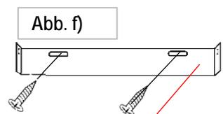
17. Bohren Sie mit einem 8mm Steinbohrer zwei 40 mm tiefe Löcher bei den Bleistiftmarkierungen und setzen Sie zwei Dübel.
