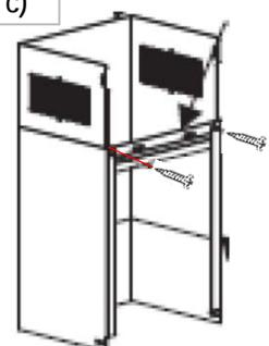
9. Drücken Sie den Kaminschacht fest an die Wand und markieren Sie mit Bleistift die zwei Bohrlöcher durch die Löcher in der Kamin Montageplatte (**Abb. d**)
