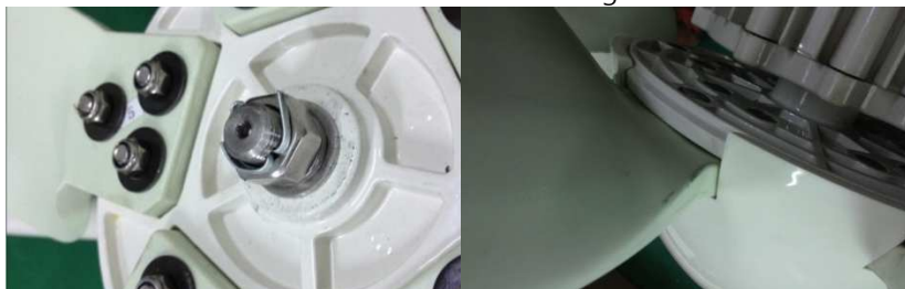
Führe den Sicherungssplint ein und biege die Enden um
