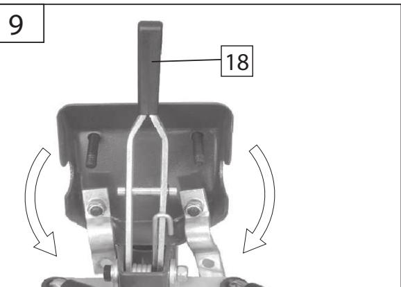
**DE** Lösen Sie die beiden Muttern an der Halteplatte (e), drehen Sie die zwei Halteplatten um 180 °.
