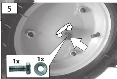
**DE** Lösen Sie die Schraube am Wellenende und entnehmen Sie die Einstellunterlegscheibe. Montieren Sie die Räder auf der Achsenwelle und stellen sicher, dass der Achsenbolzen in die Nut eingerastet ist. Fixieren Sie das Rad jetzt wieder mit der Einstellunterlegscheibe und der Schraube. Wiederholen Sie den Vorgang auf der anderen Radseite.
