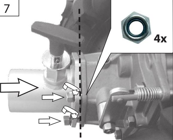
**DE** Lösen Sie die vier Muttern an der Sicherungsbolzenaufnahme (d). Bauen Sie die Kupplungshülse (c) ein und ziehen die Muttern wieder an.
