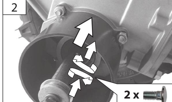
**DE** Lösen Sie die beiden Schrauben aus dem Getriebe. Schieben Sie den Schutz (a) auf die Radachse und fixieren diesen wieder mit den beiden Schrauben. Wiederholen Sie diesen Vorgang auf der anderen Radseite.
