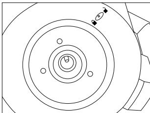
Durch einen versteckten Schalter auf der **Unterseite** des Wasserkochers aktivieren Sie die Kindersicherung. Ab jetzt erhitzt der Wasserkocher das Wasser nur noch auf die gewünschte Temperatur, wenn Sie die gewählte Temperatur-Taste noch einmal durch drücken der Koch-Taste bestätigen.
