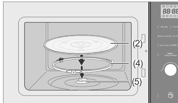
1. Den Drehtellerantrieb (5) ggf. in die Aussparung in der Mitte einsetzen.
