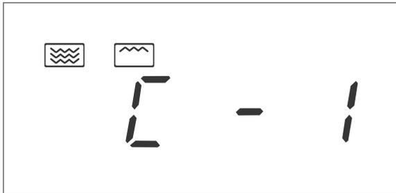
2. Drücken Sie einmal den Sensor „Grill / Kombi.“ (24). Drehen Sie den Drehregler (3) oder drücken Sie wiederholt den Sensor „Grill / Kombi.“ (24), bis im Display die Anzeige [-1 bzw. [-2 blinkt, und die Symbole (13) und (14) angezeigt werden.
