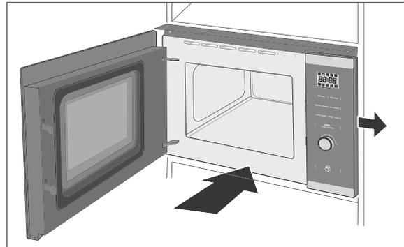
1. Schieben Sie das Gerät rechtsbündig in das Einbaufach, bis die Frontblende auf dem Rahmen des Einbaufachs auftritt.
