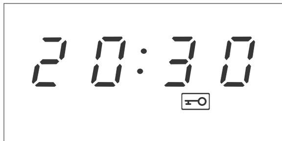
Die Aktivierung der Sicherungsverriegelung ist nur möglich, wenn das Gerät nicht in Betrieb ist.
