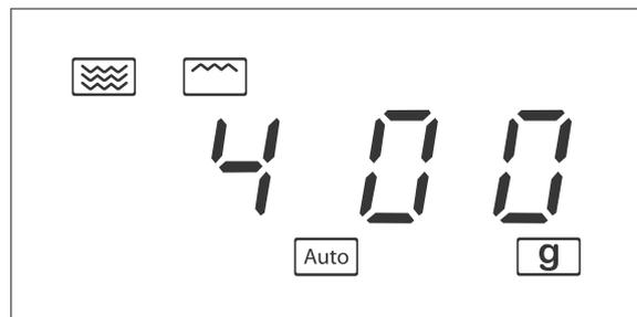
9. Drücken Sie den Sensor „START / +30Sek. / Bestätigen“ (27), um das gewählte Gewicht zu bestätigen. Das Gerät startet. Der Ventilator läuft an. Die Lampe im Garraum schaltet sich ein. Der Glasdreheller beginnt sich zu drehen. Im Display wird die vorprogrammierte Zeit heruntergezählt. Die Symbole des gewählten Automatikprogramms blinken. Sobald die Garzeit abgelaufen ist, ertönen 5 Signaltöne. Das Gerät schaltet sich aus. Das Display zeigt wieder die Uhrzeit an.
