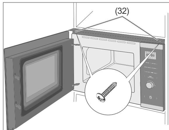
2. Schrauben Sie das Gerät in den Bohrungen (32) mit den mitgelieferten Schrauben mittels eines Kreuzschlitzschraubendreher fest.
