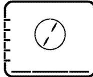
Unterhitze und Heißluft sind in Betrieb. Besonders zum Backen von Pizza geeignet.
