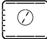
Oberhitze, Unterhitze und Heißluft sind in Betrieb. Das Gargut wird gleichmäßig und schnell von allen Seiten gegart. Nur ein Blech verwenden.
