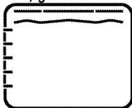
Der große Grill an der Oberseite des Backofens ist in Betrieb. Diese Betriebsart eignet sich insbesondere zum Grillen größerer Fleischmengen.
