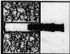
Beiliegendes Befestigungsmaterial eignet sich nur für Massivwände.
