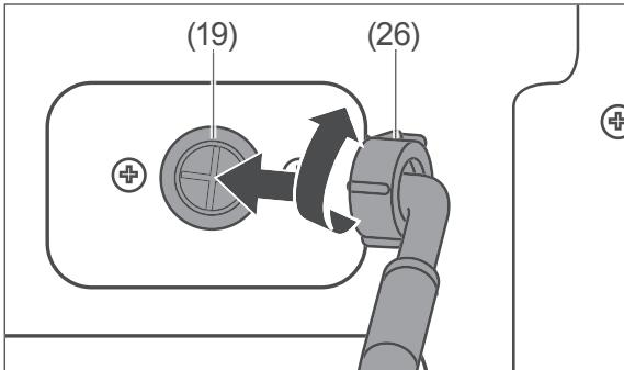
5. Schrauben Sie den Wasser-Zulaufschlauch vom Gerät ab.
