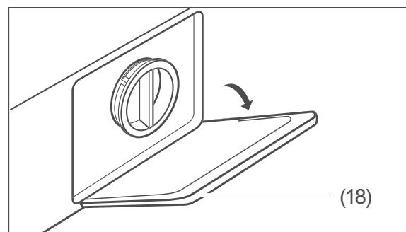
3. Öffnen Sie die Blende (18) der Fremdkörperfalle vorsichtig mit einem flachen Gegenstand, z. B. einem Schlitzschraubendreher.
