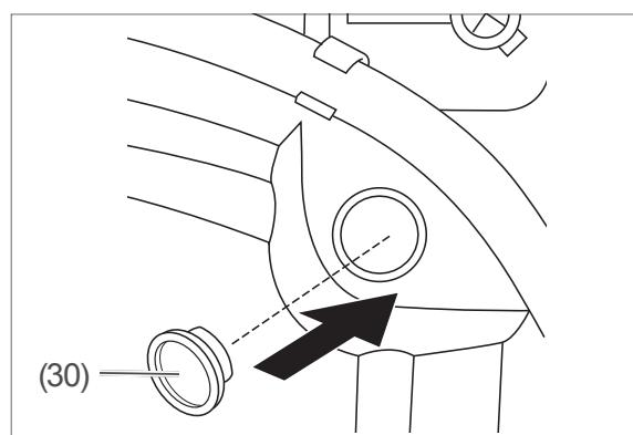
3. Verschließen Sie die Öffnungen mit den beiliegenden Abdeckungen (30).
