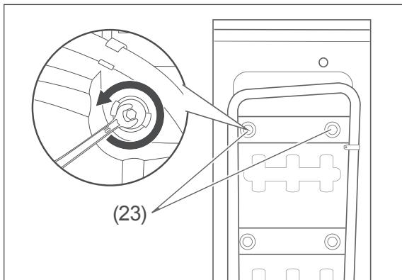
1. Lösen Sie die Schrauben der Transportsicherungen (23) mit einem 10er-Schraubenschlüssel.
