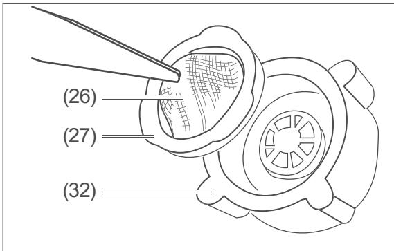
6. Ziehen Sie das Sieb (26) mit der Dichtung (27) mithilfe einer Pinzette oder Zange aus der Überwurfmutter (32) heraus. Spülen Sie das Sieb unter klarem Wasser ab und reinigen Sie es ggf. mit einer kleinen, weichen Bürste.
