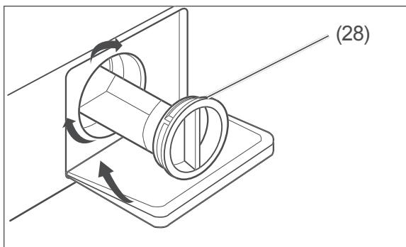
8. Setzen Sie die Fremdkörperfalle (28) wieder ein, und schrauben Sie sie bis zum Anschlag fest.
