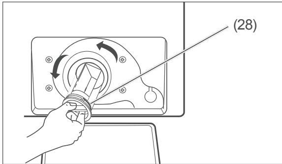
4. Stellen Sie einen passenden Auffangbehälter unter die Fremdkörperfalle (28).
