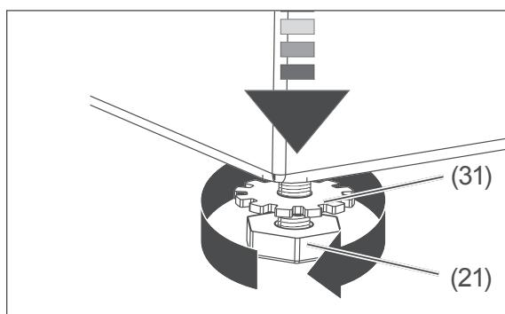
1. Lösen Sie die Kontermutter (31) eines Schraubfußes (21) auf der Geräte-Unterseite.
