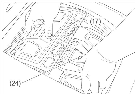
3. Zum Öffnen der Waschtrommel (17) drücken Sie die Kunststoffnase (24) an der kleineren Deckelhälfte etwas nach unten, bis die Verschlusshaken ausrasten.
