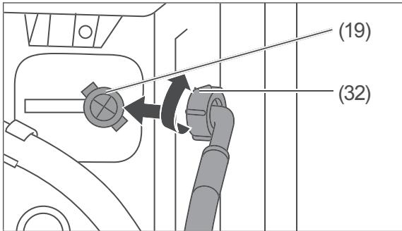
1. Schrauben Sie den beiliegenden Wasser-Zulaufschlauch handfest am Anschlussstutzen (19) fest. Drehen Sie dazu die Überwurfmutter (32) im Uhrzeigersinn.
