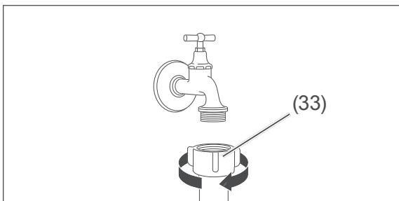
2. Befestigen Sie das andere Ende des Wasser-Zulaufschlauchs handfest am Wasserhahn. Dazu die Überwurfmutter (33) im Uhrzeigersinn drehen.
