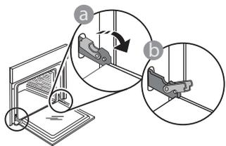
1. Zur Entfernung der Tür diese vollständig öffnen und die Haken senken, bis sie sich in entriegelter Position befinden.
