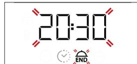
oder verwenden zum Einstellen der Abschaltzeit und zur Bestätigung drücken. Die Funktion durch Drehen des *Thermostatreglers* auf die gewünschte Temperatur aktivieren: Die Funktion ist angehalten, bis sie automatisch nach der berechneten Zeit startet, damit der Garvorgang zur eingestellten Zeit endet.
