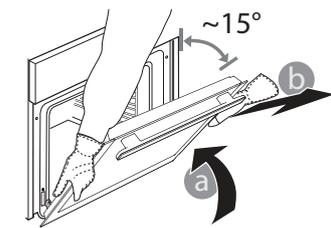
2. Die Tür so weit wie möglich schließen. Die Tür mit beiden Händen festhalten – diese nicht am Griff festhalten. Die Tür einfach entfernen, indem sie weiter geschlossen und gleichzeitig nach oben gezogen wird, bis sie sich aus
