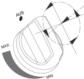
Sollte der Zündversuch auch nach mehrmaligem Betätigen der elektronische Zündvorrichtung erfolglos bleiben, drehen Sie den Bedienknopf des Regelventils wieder auf "AUS".
