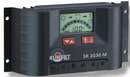
Bei den Monitor Typen zeigt ein grafisches Display selbsterklärend alle Systeminformationen an. Für den Betrieb in Lichtsystemen bieten diese Reglertypen zusätzlich eine Nachtlichtfunktion der Verbraucher von bis zu 8 Stunden. Die Batteriekapazität wird durch einen selbstlernenden Algorithmus sehr genau ermittelt. Ein zusätzliches Highlight ist der manuelle Lasttrennschalter.
