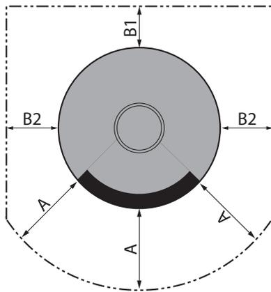
Distances de sécurité minimales à respecter par rapport à tout matériau de construction inflammable :
