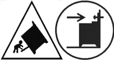
**Warnung:** Um ein Umkippen des Geräts zu verhindern, muss diese Stabilisierungsmaßnahme installiert werden. Siehe dazu die Installationsanleitung.
