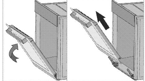
4. Nehmen Sie die Ofentür heraus, indem Sie diese etwas anheben und von den Scharnieren rechts und links lösen.
