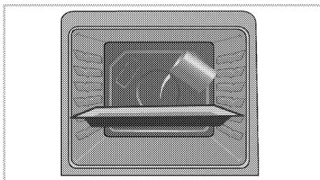
3. Stellen Sie den Backofen auf einfache Dampfreinigung ein, lassen Sie ihn bei 100 °C 25 Minuten laufen.
