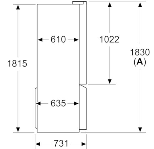
**A:** Front ist von 1830 bis 1847 (bei voll ausgezogenen vorderen Nivellierfüßen) verstellbar
