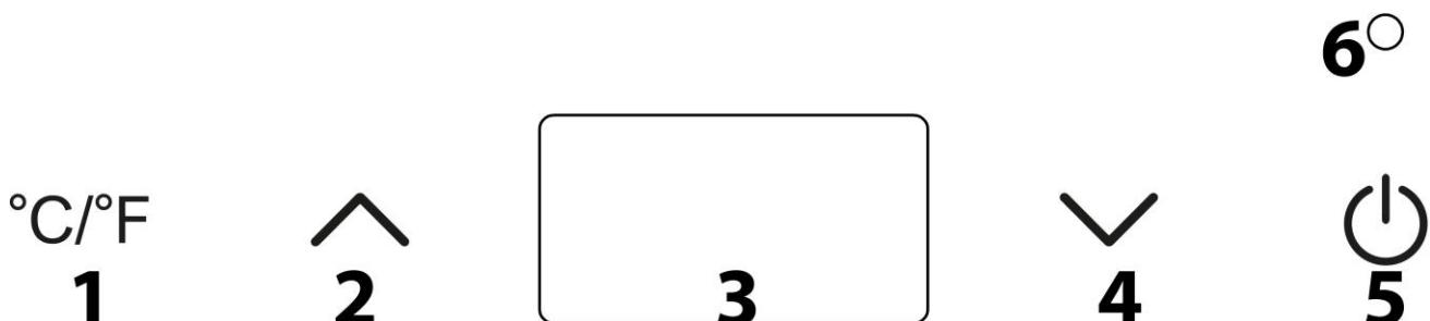
1 Conversion de °C en °F, ainsi que l'affichage de la température actuelle à l'intérieur du refroidisseur de bouteilles de vin
