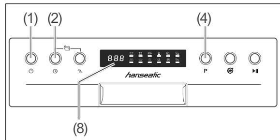
2. Drücken Sie innerhalb von 60 Sekunden nach dem Einschalten 5 Sekunden lang die Taste **P** (4).
