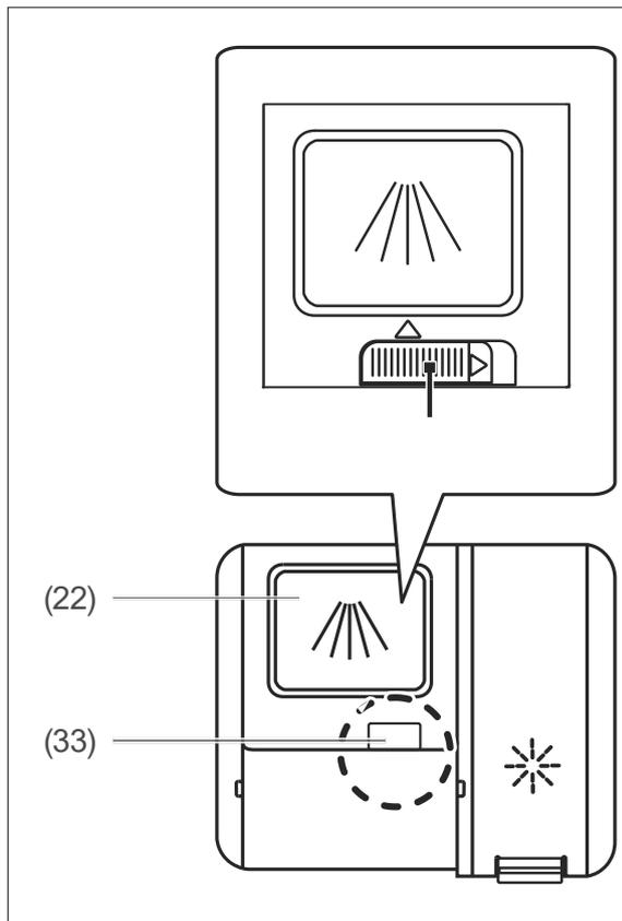
1. Schieben Sie den Verschluss (33) der Spülmittelkammer (22) zur Seite. Der Deckel springt auf.
