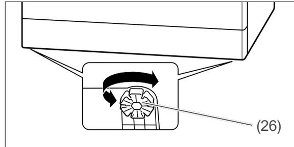
3. Um Unebenheiten des Bodens auszugleichen und den Geschirrspüler waagrecht auszurichten, können Sie die vier Gerätefüße (26) heraus- oder hineindreuen. In den Gerätefüßen sind ringsherum Schlitze angebracht. Stecken Sie hier einen Schraubendreher hinein und drehen Sie damit den Gerätefuß. Verwenden Sie zum Ausrichten des Geschirrspülers eine Wasserwaage.
