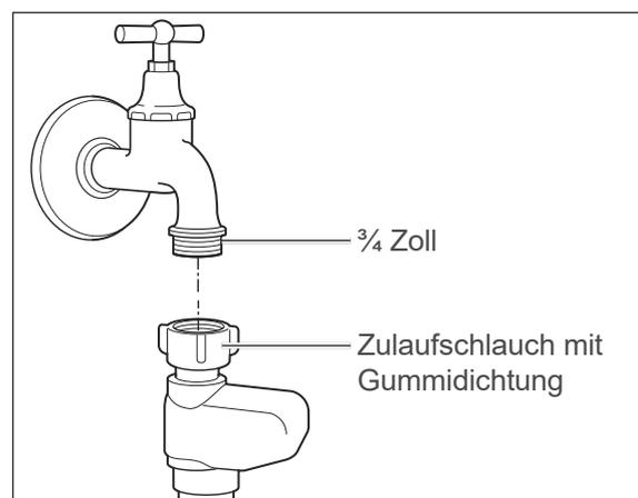
Für die Wasserversorgung benötigen Sie einen Wasserhahn mit einem 3/4 Zoll-Schraubanschluss.
