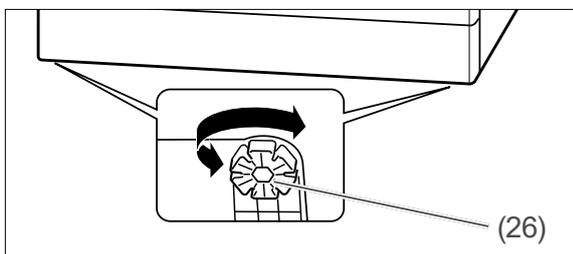
5. Um Unebenheiten des Bodens auszugleichen und den Geschirrspüler waagrecht auszurichten, können Sie die vier Gerätefüße (26) heraus- oder hineindreihen. In den Gerätefüßen sind ringsherum Schlitze angebracht. Stecken Sie hier einen Schraubendreher hinein und drehen Sie damit den Gerätefuß.
