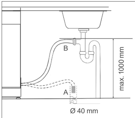
Der Abflussschlauch (22) kann auf zwei Arten angeschlossen werden:
