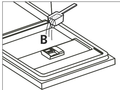
3. Geben Sie die restlichen 1/5 des Geschirrspülmittels auf die Innenseite der Tür. Diese Menge verwendet das Gerät während des Vorspülprogramms.
